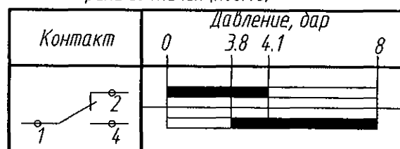
Диаграмма замыкания контактов реле давления (поз.4г)
