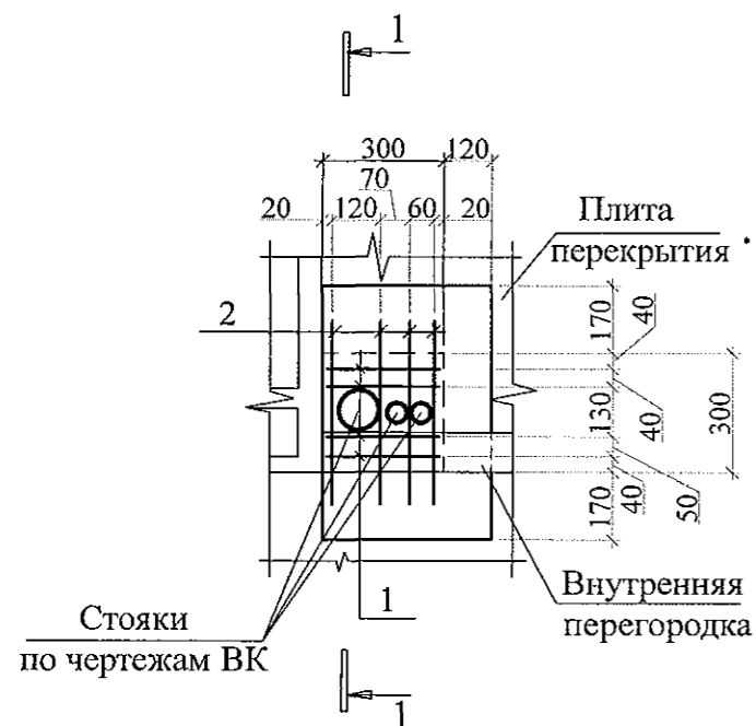
А Деталь монолитной заделки отверстия
