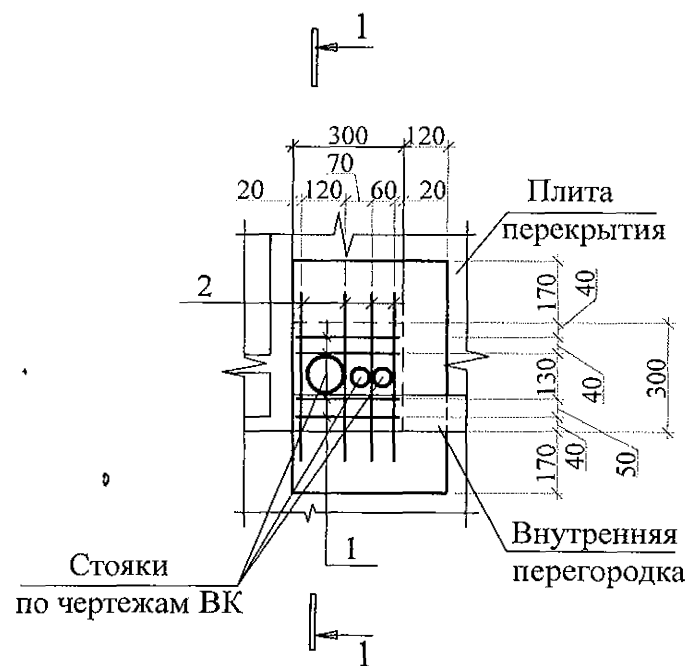
А Деталь монолитной заделки отверстия
