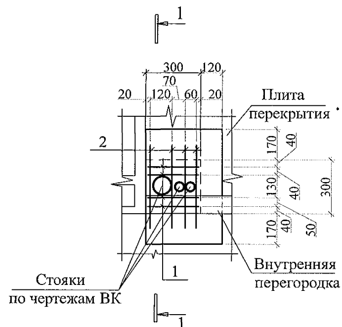
А Деталь монолитной заделки отверстия
