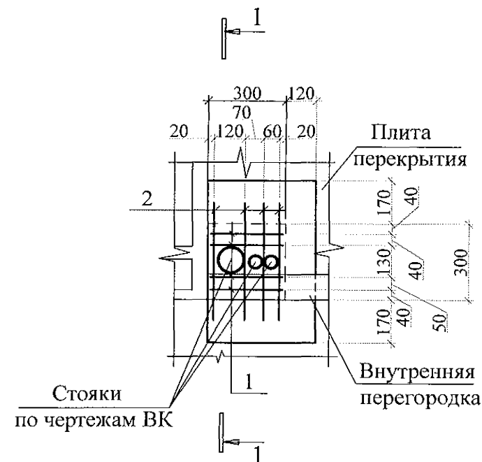
А Деталь монолитной заделки отверстия
